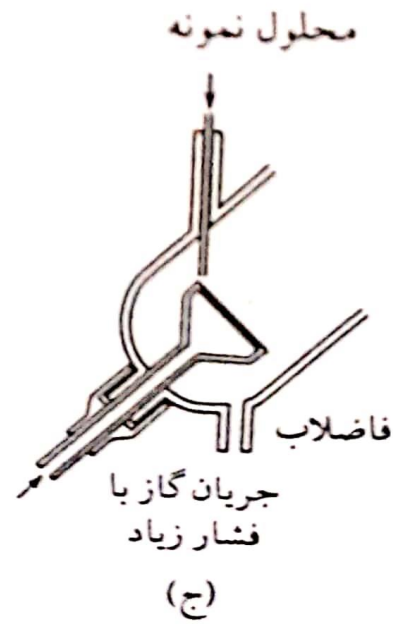
شکل ۸-۹ انواع مهپاشهای بادی: (الف) لوله هم مرکز، (ب) جریان متقاطع، (ج) صفحه متخلخل، (د) باینگتون.
